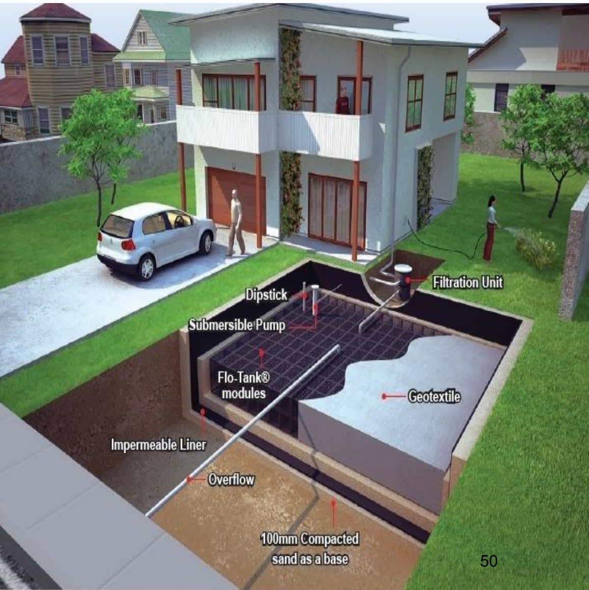
圖2-3.11地下礫石層與組合式蓄水框架的地下貯集滲透工法
