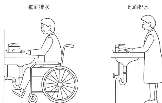
圖 3-37 洗臉盆檯面下方的水管
